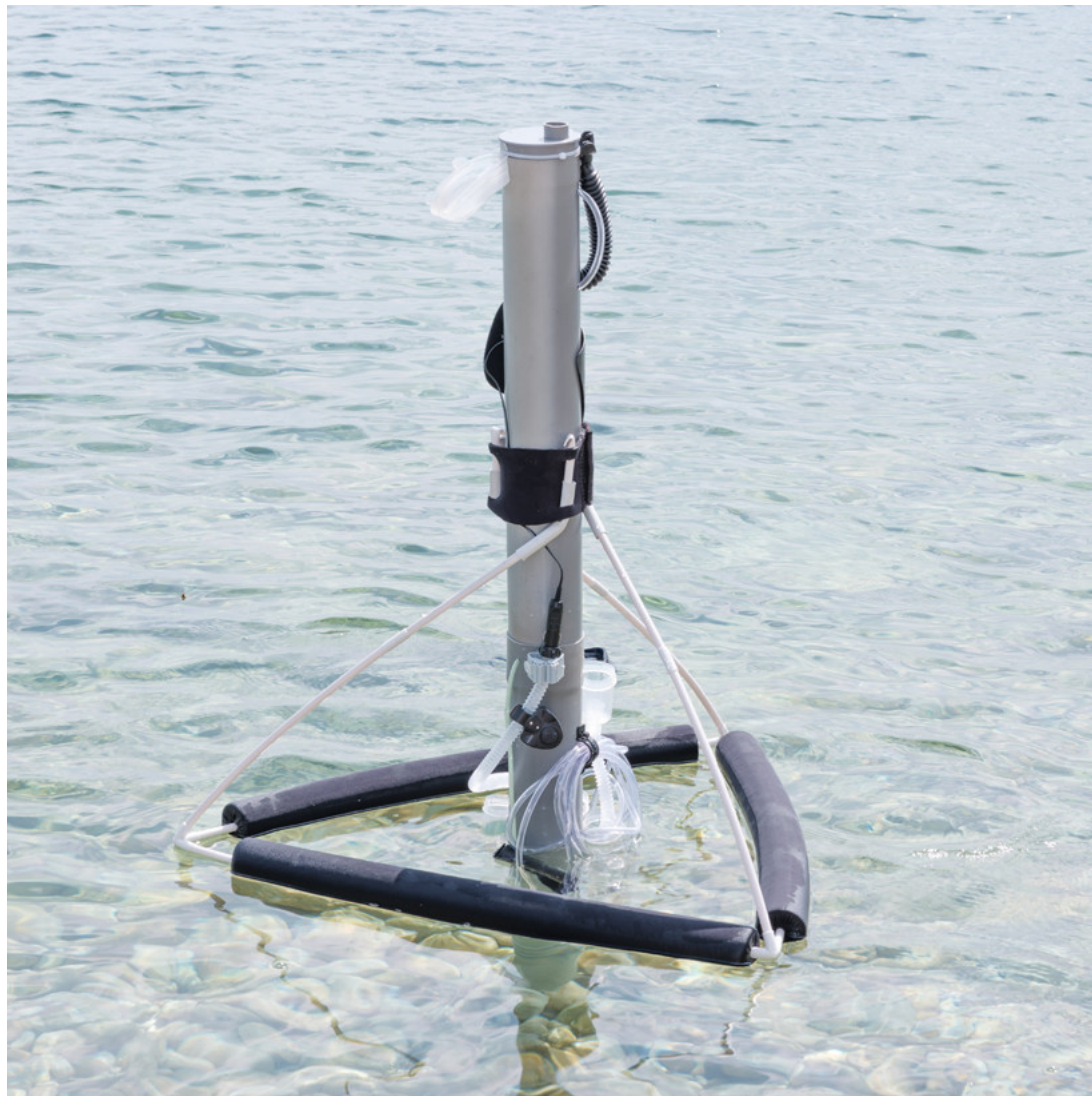
Outil de mesure AquaQuaz™ FILTRATION MECHANIC CORE (et flotteur de stabilisation). 4880g, 10×20×160cm. Carottage avec résultats concluants dès 3min d'utilisation ininterrompue sur zone de 100×100×70cm. Réglage contrôle: vitesse d'analyse, filtration et minuteur. Tenir fermement les poignées Contrôle et Stab et procéder au prélèvement par des gestes circulaires et fluides. Résultat d'analyse après 20min hors d'eau.
