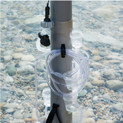
Outil de mesure AquaQuaz™ FILTRATION MECHANIC CORE (et flotteur de stabilisation). 4880g, 10×20×160cm. Carottage avec résultats concluants dès 3min d'utilisation ininterrompue sur zone de 100×100×70cm. Réglage contrôle: vitesse d'analyse, filtration et minuteur. Tenir fermement les poignées Contrôle et Stab et procéder au prélèvement par des gestes circulaires et fluides. Résultat d'analyse après 20min hors d'eau.
